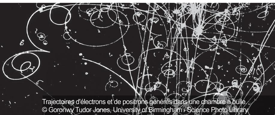
Trajectoires d'électrons et de positrons générées dans une chambre à bulle.
