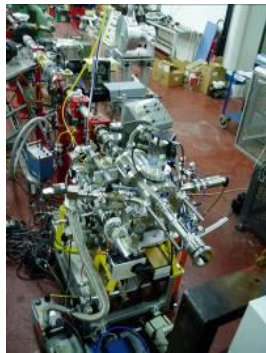
Irrad. externe (C eq. \alpha , e-) études d'émission gazeuse in situ
